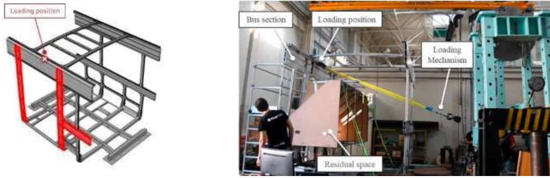
Görsel 7. Devrilme testinin nümerik ve deneysel simülasyonu [13]
