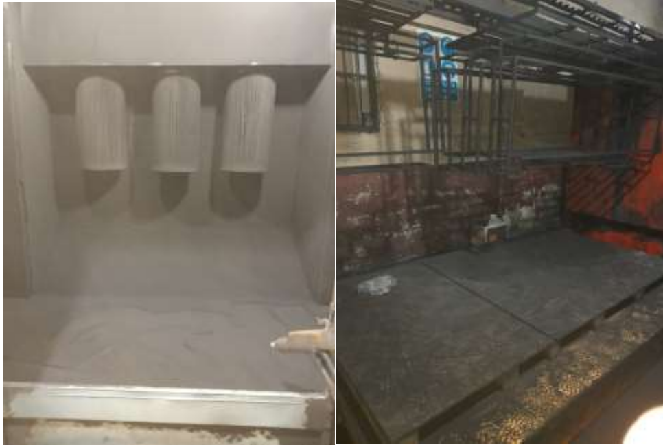
Görsel 2. İşletmenin Boyahane bölümüne ait filtre kabini (a) ve boyama ünitesi örneği (b)
