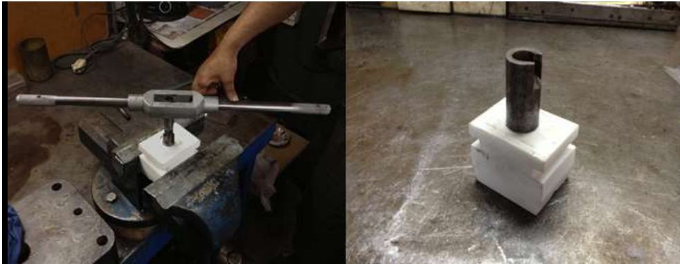
Görsel 5. Üst kalıp plakasına diş açma ve mapa montajı.
