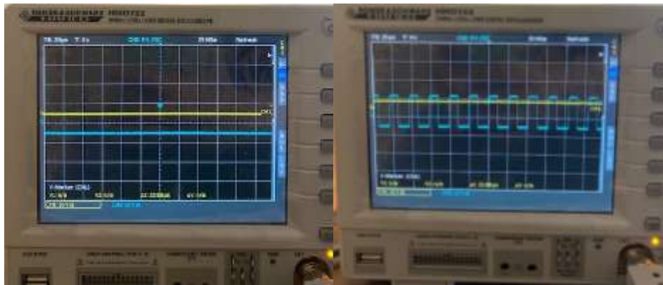
Görsel 21 PWM ve QINR1 Gate – Inrush Ok On/Off Çıktıları
