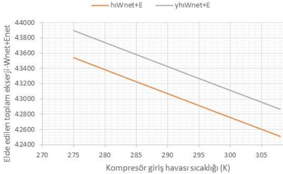
Görsel 5. Elde edilen toplam ekserjinin kompresör giriş havası sıcaklığı ile değişimi
